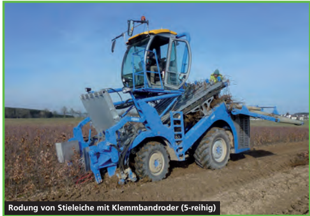
Rodung von Stieleiche mit Klemmbandroder (5-reihig)
